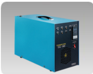
▶ 金型温調機 TSC-200 大容量金型温調機。温調媒体は水で95度対応。250tまで可能。
