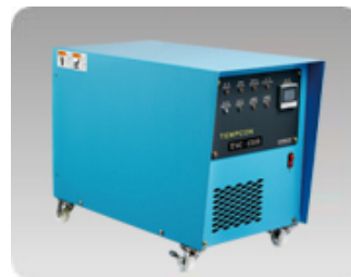
▶ 金型温調機 TSC-150B 高温仕様小型金型温調機。温調媒体は水で150度対応。プースターポンプ内蔵。
